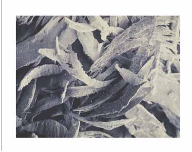
Şekil 3.2. Abrasif aşınma nedeniyle oluşan tozlar [16].
