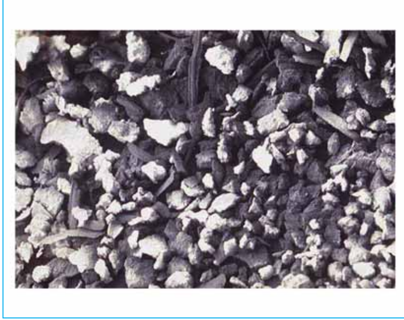
Şekil 3.12. Tel çekme yağlayıcı ile bakır tel arasındaki kimyasal reaksiyon sonucu oluşan sabunumsu bakır çamur [16].
