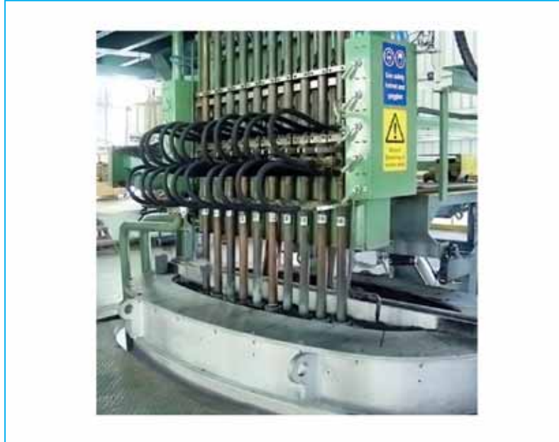
Şekil 1.4. Yukarı döküm oksijensiz bakır filmaşın üretim yönteminin kokil kalıplı döküm sisteminin görünümü [5]
