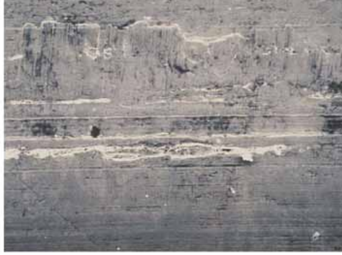
Şekil 3.7. Bakır tel yüzeyinde oluşmuş adezif aşınma görüntüsü [16].
