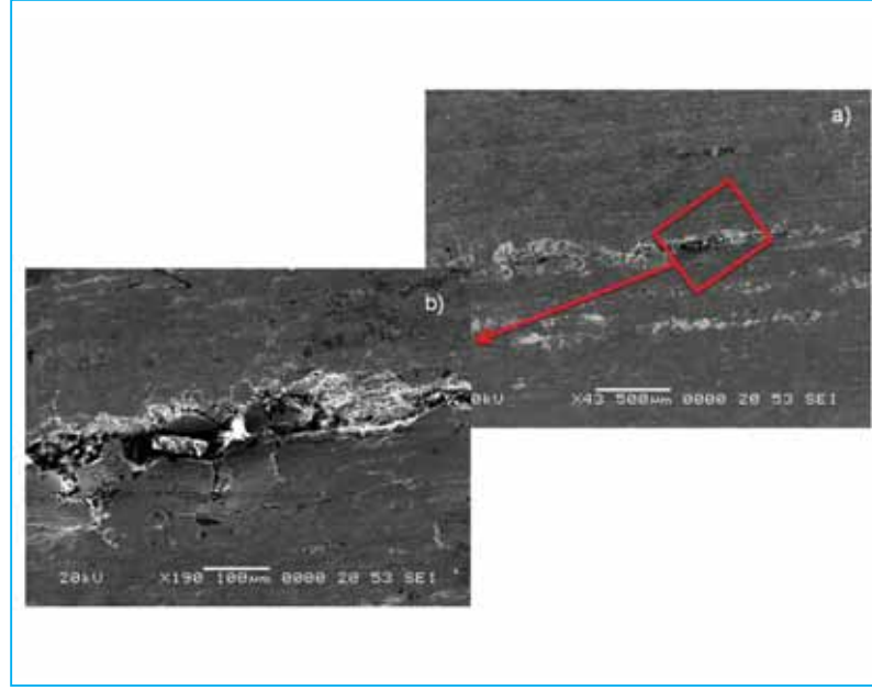
Şekil 5.7. Burma testi uygulanmış filmaşın yüzeyinin SEM görüntüsü
