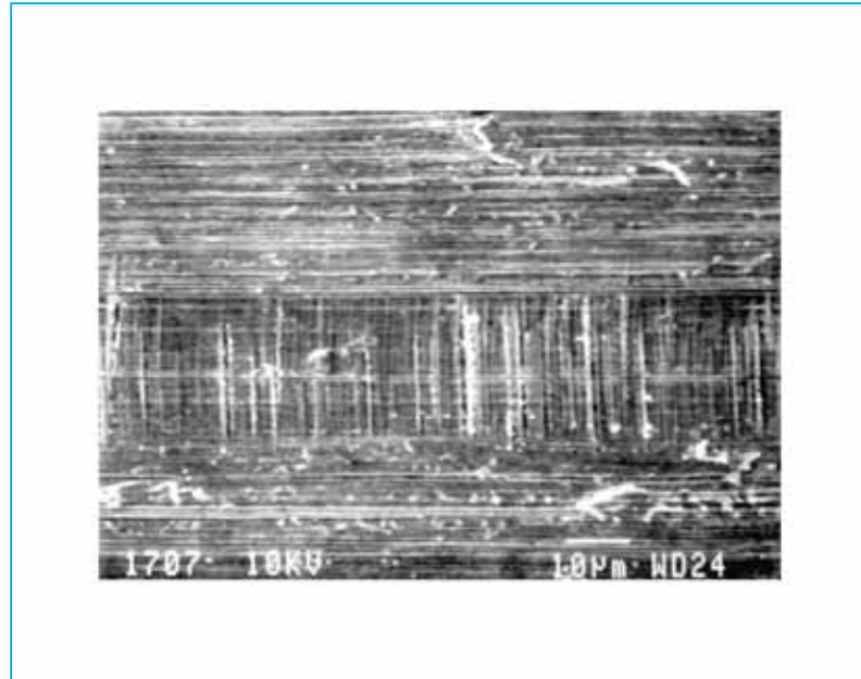
Şekil 3.15. Kalıptan çıkan telin titreşimiyle tel yüzeyinde oluşan çapraz çizik izleri [16]
