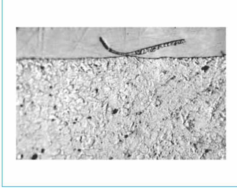
Şekil 3.9. Tel yüzeyine yapışmış delaminasyon sonucu oluşan toz görüntüsü [16].
