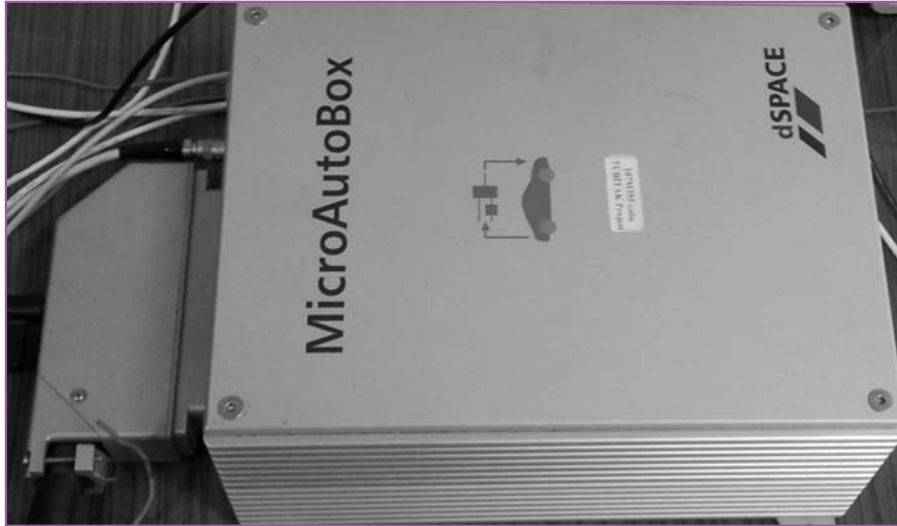
Şekil 3.23. 23 dSPACE micro autobox kontrol ünitesi
