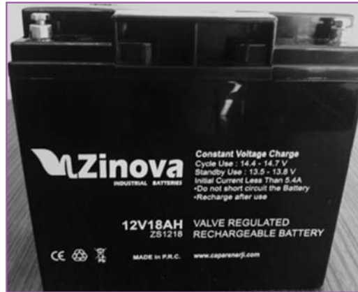
Şekil 3.19. Test platformunda kullanılan batarya grubu
