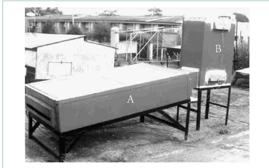
Şekil 1.4 : Hava ısıtma sisteminin resmi: (A) ısı depolama ve diğer ekipmanları içeren kollektör, (B) ısıtılan hacim (Enibe, 2002).
