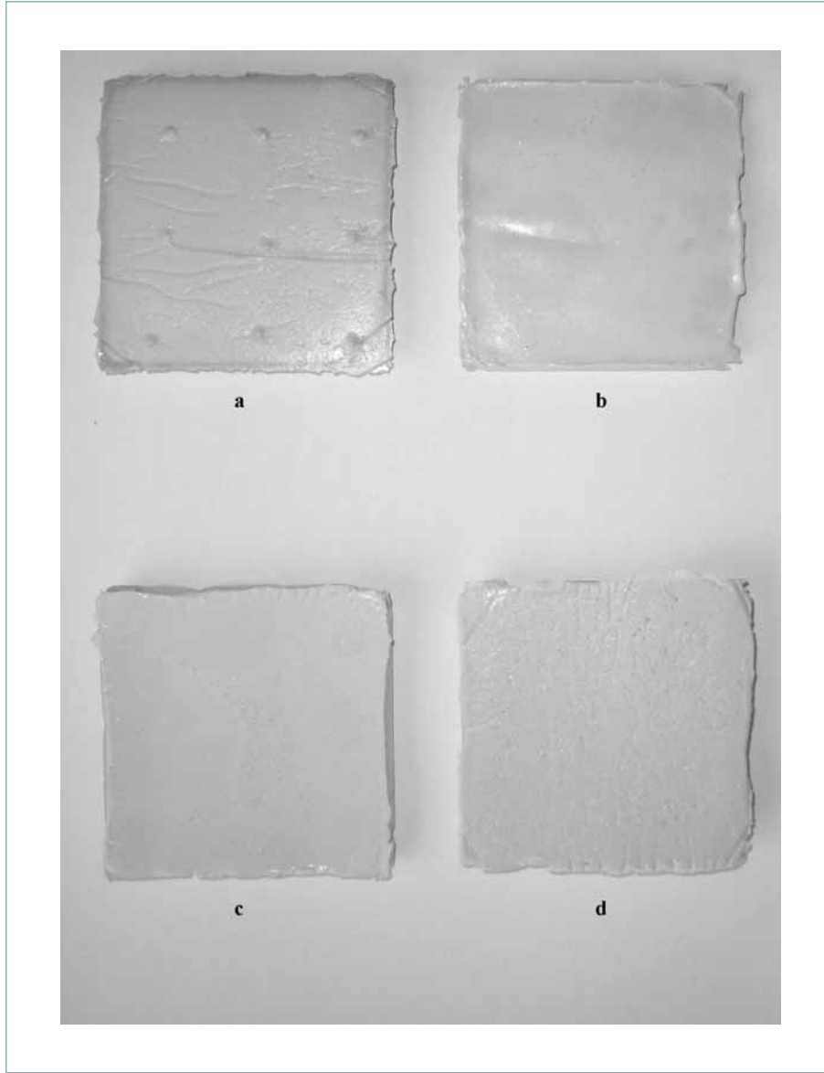
Şekil 4.12 : PU - FDM kompozitleri: (a) referans, (b) % 9,2, (c) % 13,9 ve (d) % 22,6 FDM içerikli kompozitler.
