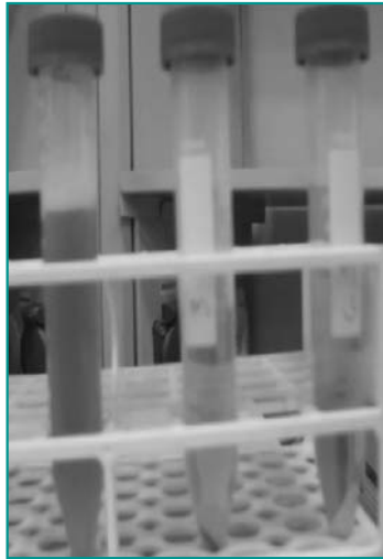
Şekil 8.24. Çalkalamasız su banyosunda 4. gün sonunda 3 farklı konsantrasyonda AB 1 boyasının giderilmesi (mavi renk-kontrol)
