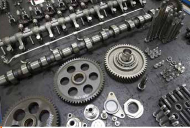
Isıl işleme ihtiyaç duyan bazı motor parçaları
