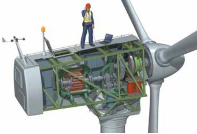
Rüzgar jeneratörü içinde bulunan dişli aksamlar
