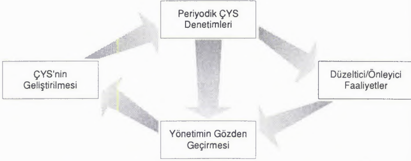
Şekil 7. ÇYS Denetimleri, düzeltici/önleyici faaliyet ve yönetimin gözden geçirmesi prosesleri arasındaki ilişkiyi gösterir şema
