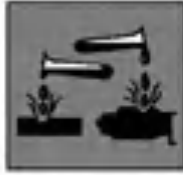
Korozif (aşındırıcı) C
