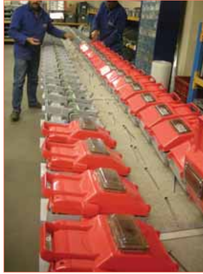
Şekil 25: Küçük Kutuların “Biriktir-Beklet” Biçimli Montajı
