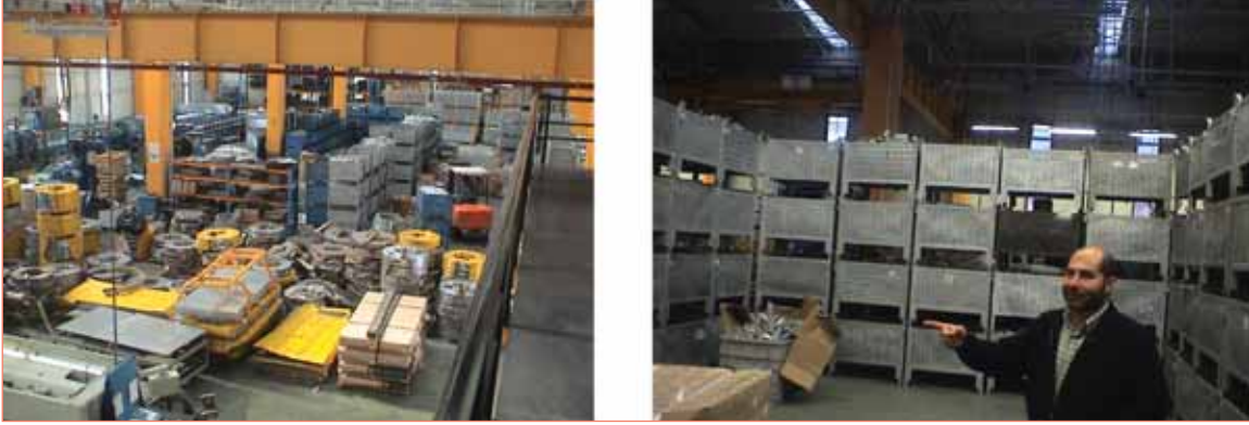
Şekil 42: Depoda Kasaların Düzensiz Depolanmasından U-Biçimli Depo Düzenine Geçiş
